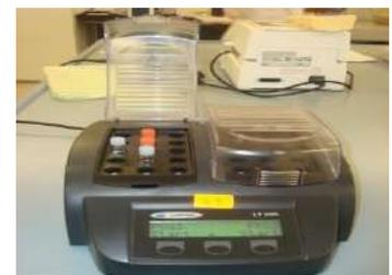
**Réacteur DCO****Photo III. 23 : Appareils et réactifs pour mesure DCO**
