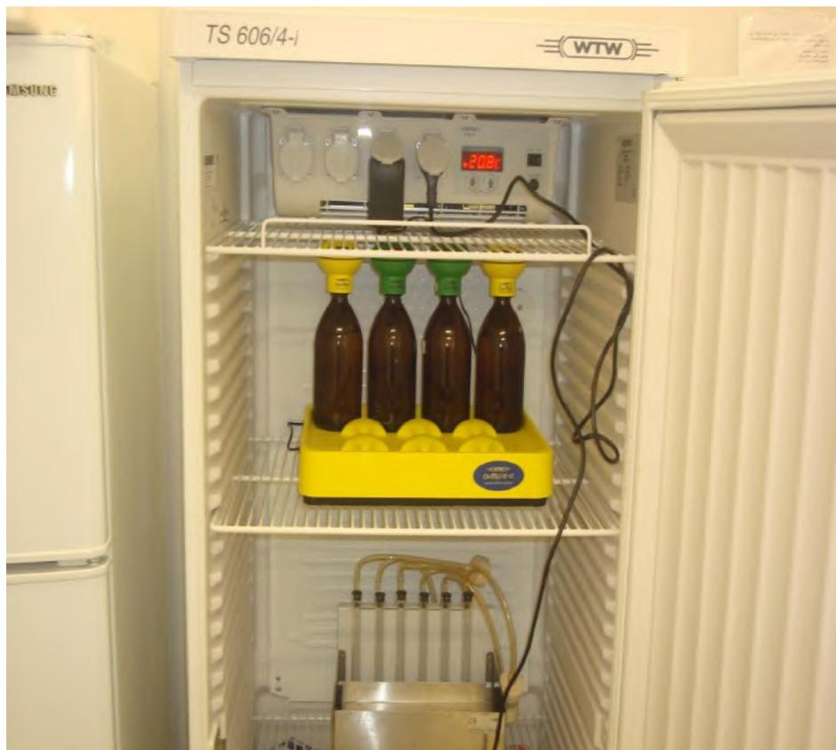
**Photo III. 24 :Réfrigérateur, Bouteilles et OXI TOP**
