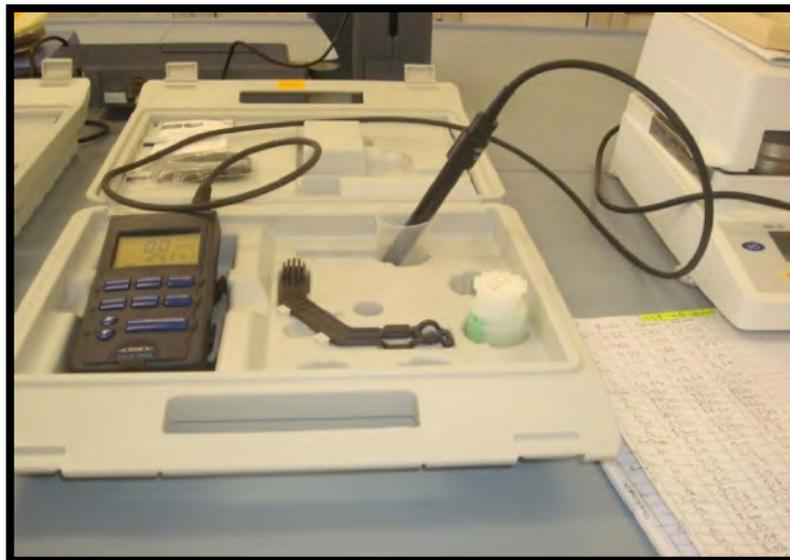
**Photo III. 18 : Conductimètre**
