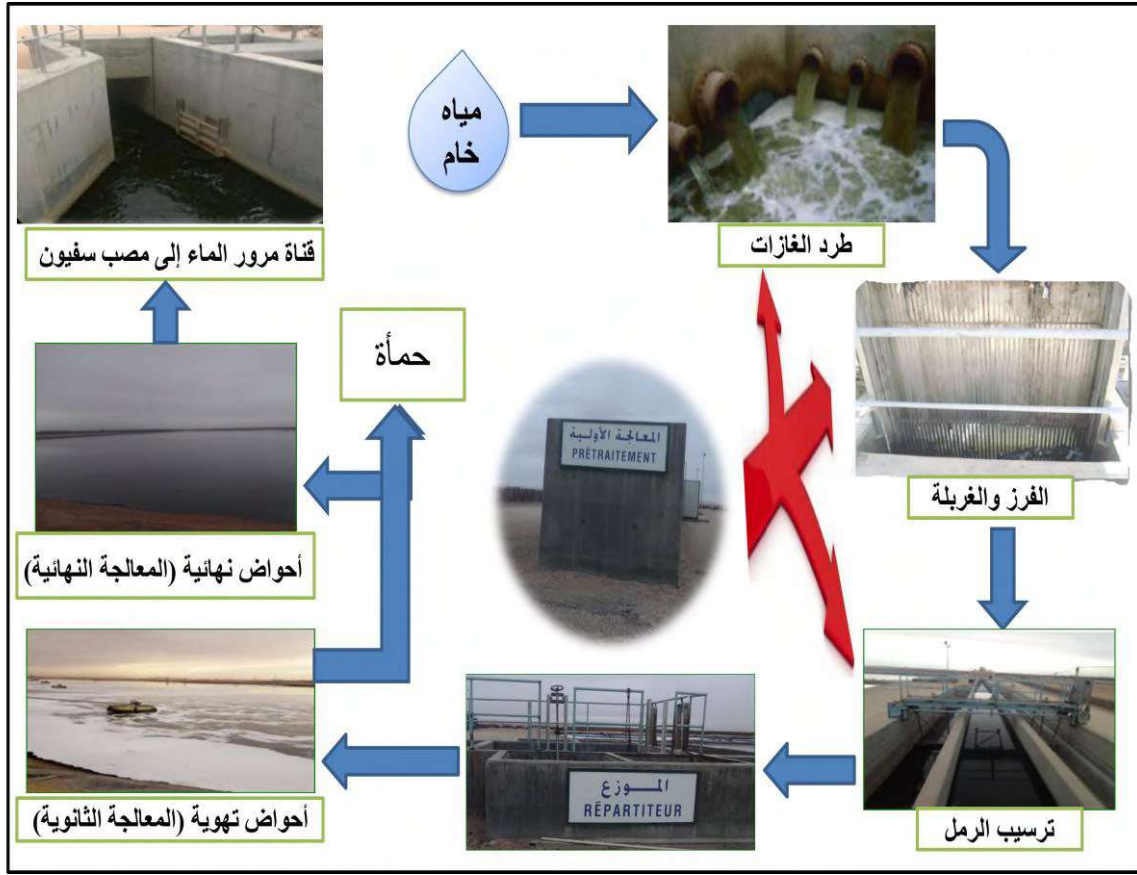
الشكل (38): مراحل معالجة المياه على مستوى المحطة.
