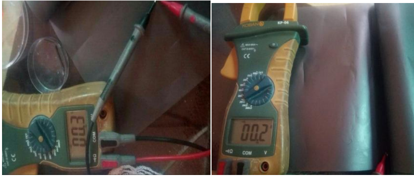
الشكل (6.III) : قياس المقاومة لعينة من الجرافين بتقنية التغليف الحراري.
