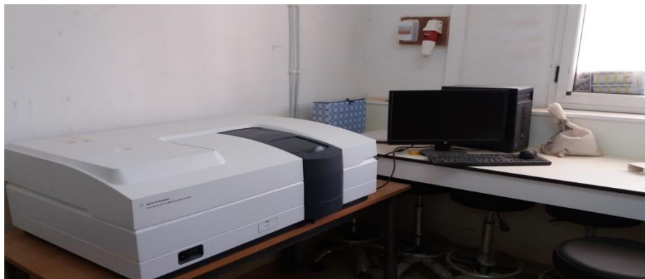
الشكل (10.II): جهاز التحليل الطيفي (UV-Vis).
