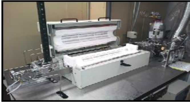
الشكل (8.I) : غرفة الترسيب الكيمائي للطور البخار (CVD) [11].
