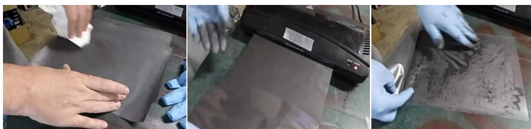
الشكل (II.7): الحصول على الجرافين بتجربة التغليف الحراري [38].
