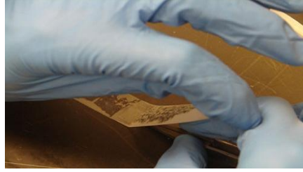
الشكل (2.1.II): تكرار عملية التقشير بالشريط اللاصق [33].
