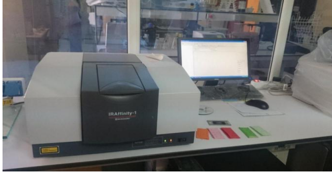
الشكل (12.II): جهاز مطيافية ما تحت الحمراء ولواحقه [39].
