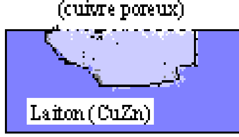
الشكل (7-I): رسم تخطيطي للتآكل الإختياري
