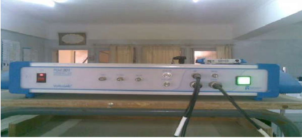
الشكل (II-1): جهاز Potentionstat-Galvanostat من النوع PGZ 301.
