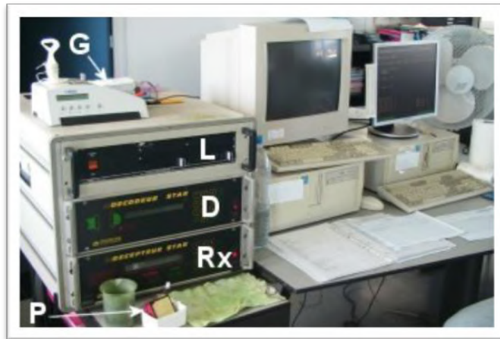
Figure (I.7) : Poste de suivi de radiosonde VAISALA
