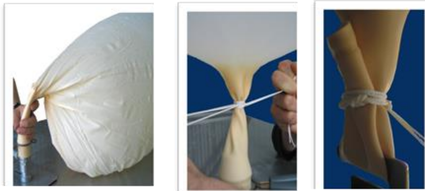
Figure (1.4) : Gonflage, serrage et rabat du col du ballon
