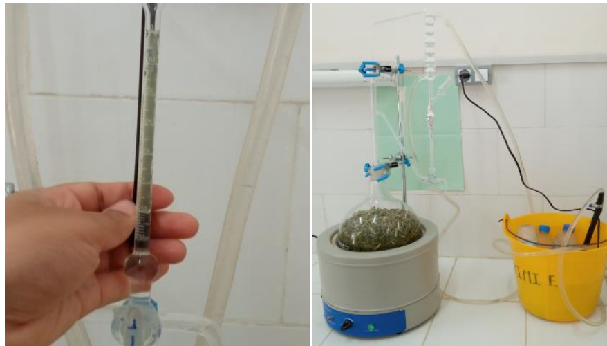
Photo. 05: photo du montage clevenger employé pour l'extraction des HE.
