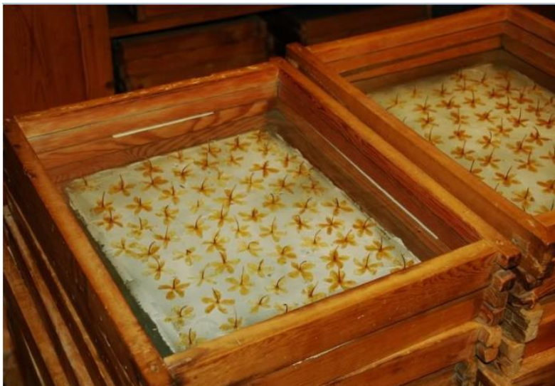
Photo. 02 : Photo démonstratif de l'enfleurage à froid.
