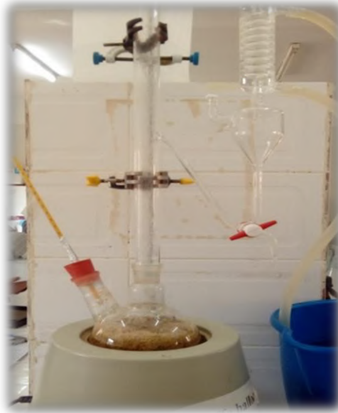
الشكل (IV-2): صورة فوتوغرافية لجهاز كليفنجر Clevenger المستخدم في عملية التقطير. نفس الخطوات والحجوم والاوزان تستعمل في الطريقة الثانية:
