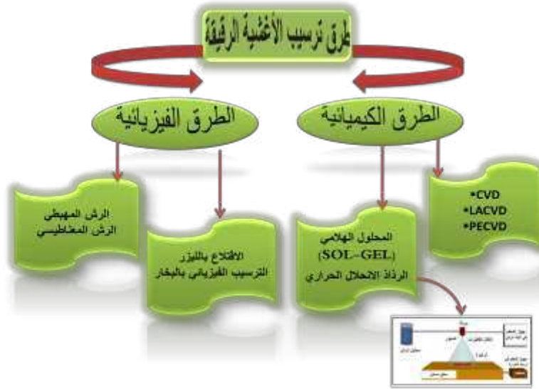
الشكل (II-4): يوضح طرق ترسيب الأغشية الرقيقة [18].
