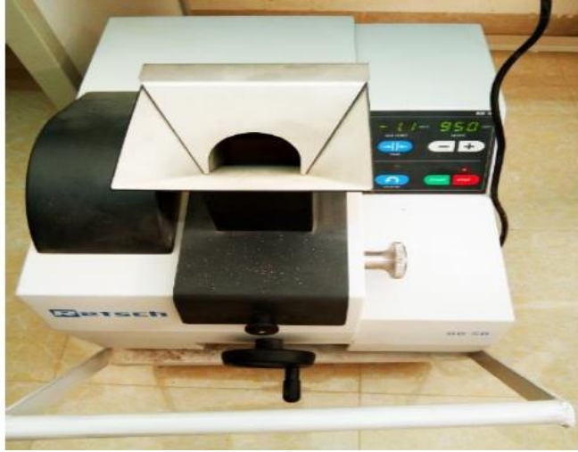
الشكل (II-5): صورة توضح الجهاز المستعمل في سحق عينات الصخور.
