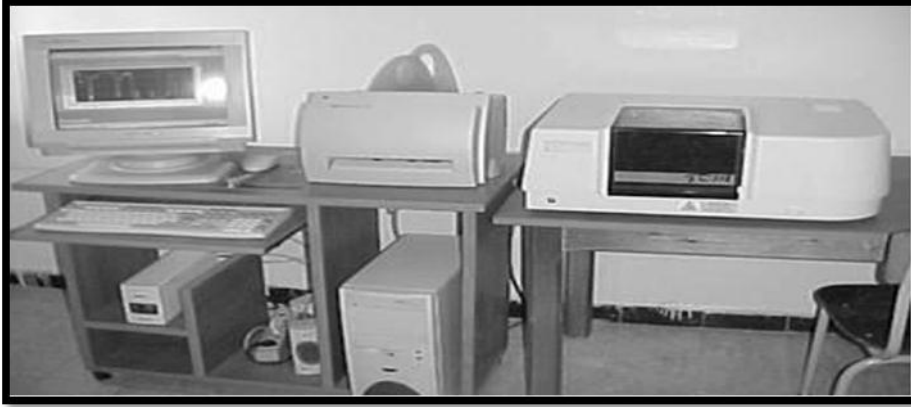
الشكل (III.18): مخطط مطياف الامتصاص ما تحت الأحمر ولواحقه.
