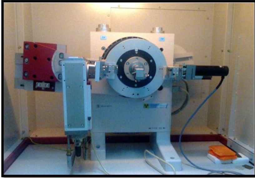
الشكل(III.16): صورة لجهاز انعراج الأشعة السينية SEIFERT XRD 3003 TT.
