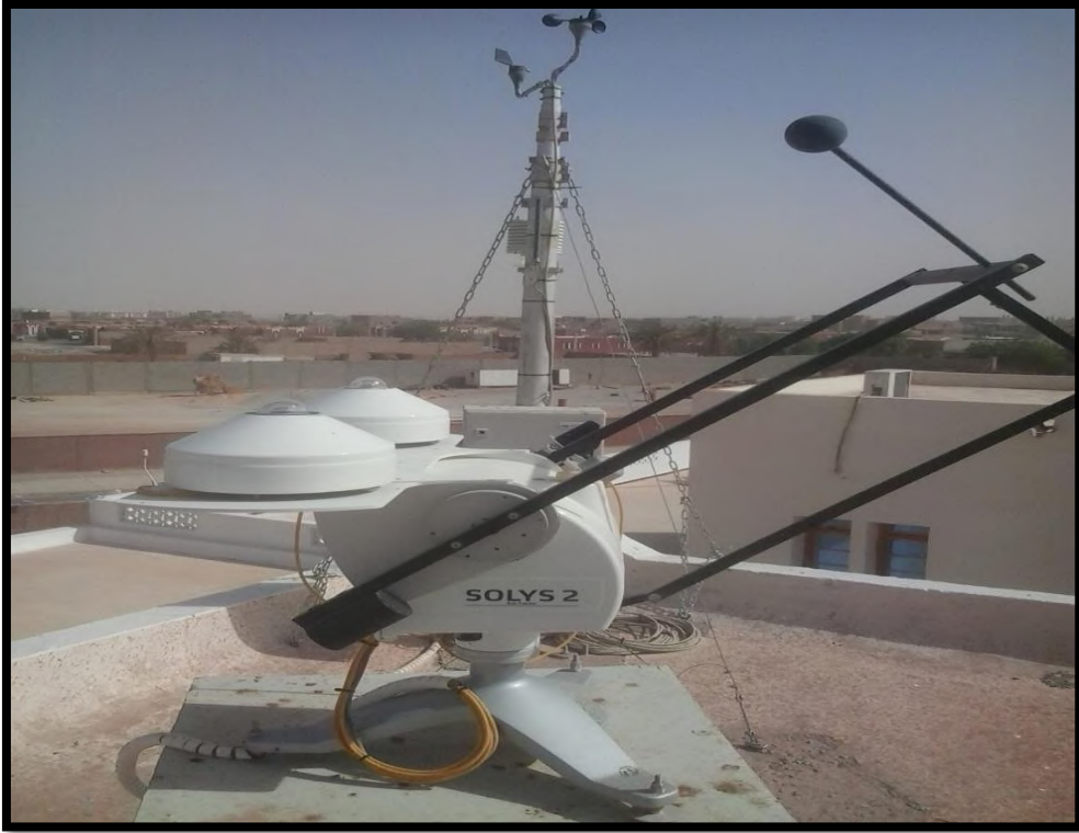
الشكل (1-3): محطة Urer-ms- لقياس الإشعاع (أدرار).
