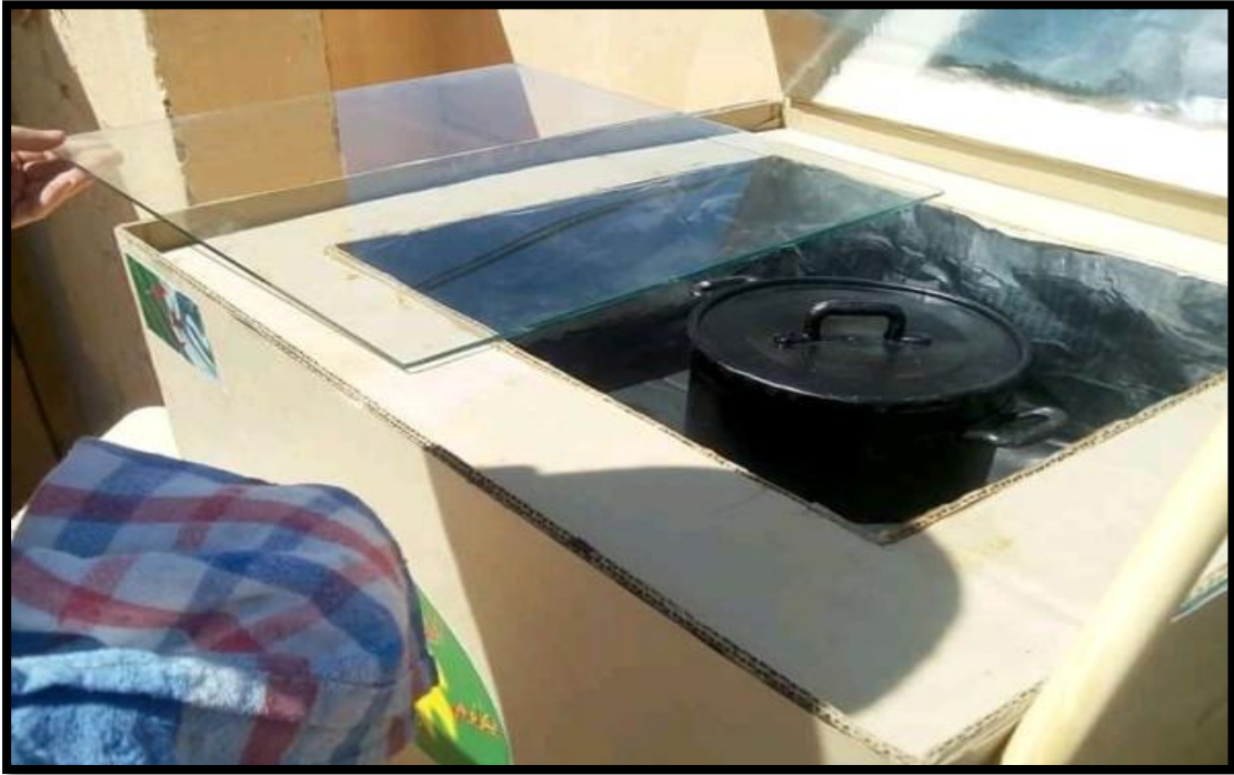
الشكل (3-2): كيفية وضع العازل وطباخة شمسية بسيطة (المصدر من إعداد الطلبة).
