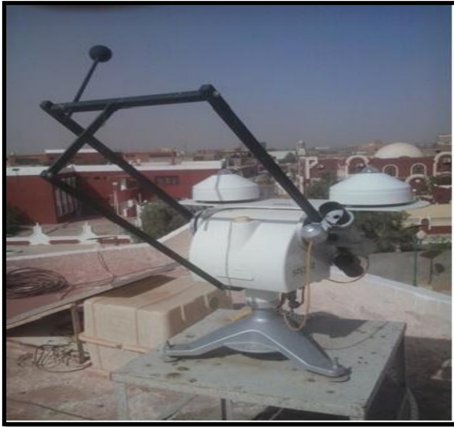
الشكل(8-1): جهاز البايروهليومتر لقياس الإشعاع الشمسي المباشر
