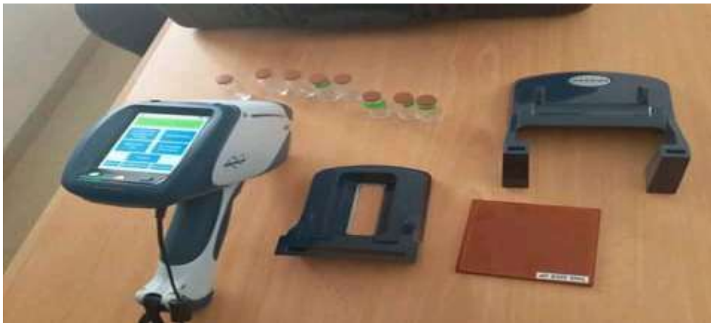
الشكل (III_6): صورة فوتوغرافية لجهاز الفلورة أثناء القياس لعينة الهواء
