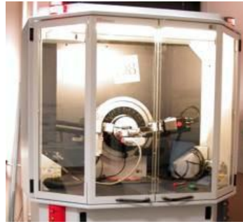
الشكل 6-IV: جهاز حيود الأشعة السينية D8 Advence Bruker . [27]
