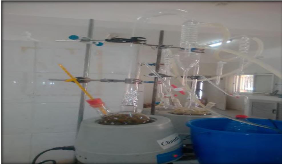
شكل(III-3): الإستخلاص بجهاز كليفنجر Clevenger.
