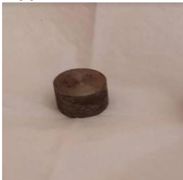
Figure (I. 1) : Une électrode cylindre en acier xc52
