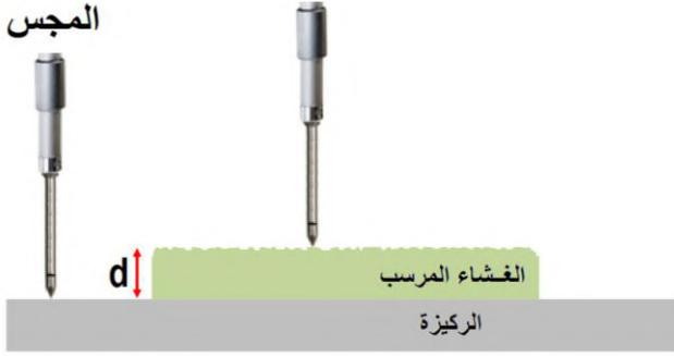
الشكل 43. قياس السماكة باستخدام البروفيلومتر .
