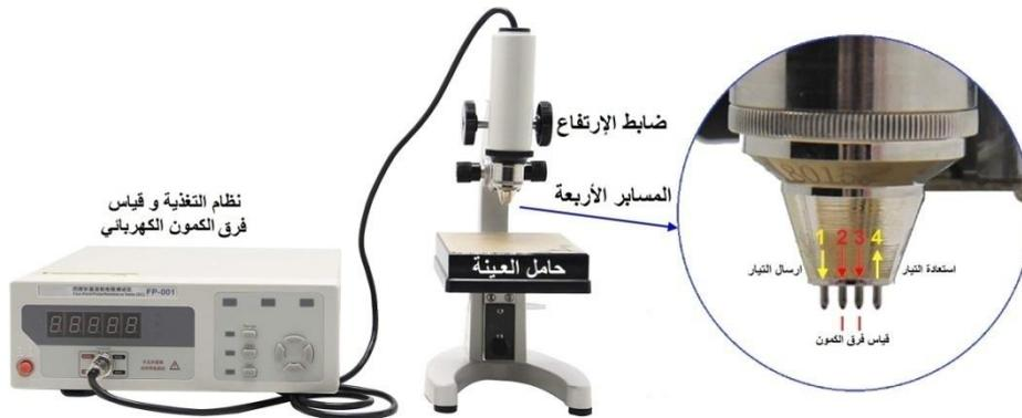
الشكل 44 . منظومة قياس المقاومة النوعية للأغشية الرقيقة بتقنية المسابر الأربعة.
