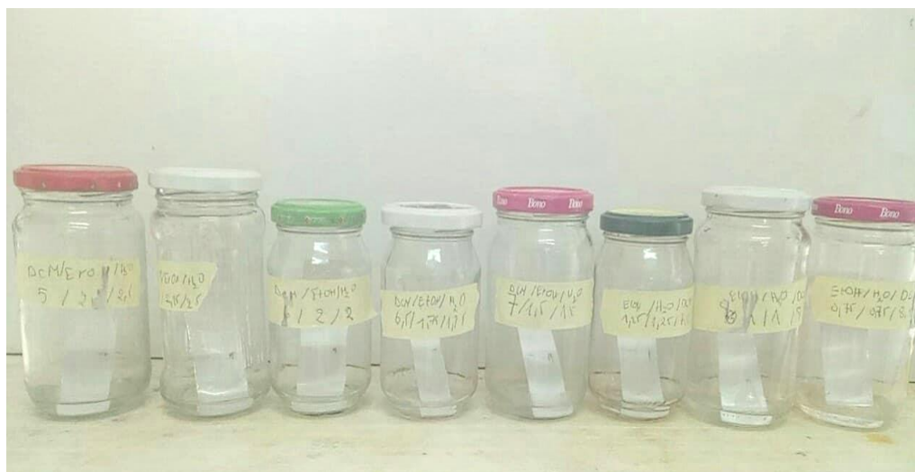
Figure .26. Les systèmes de CCM utilisés pour l'analyse de l'extrait butanolique [BMD].
