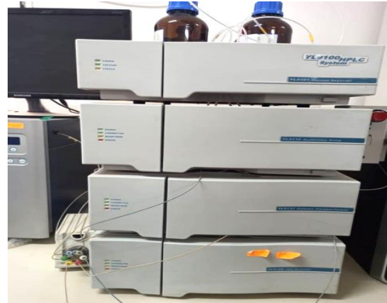
Figure .27. Appareil HPLC YL 9100 utilisé dans notre travail..
