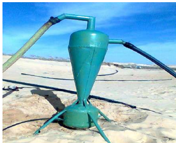
Photo n° 22 : Filtres pour système goutte à goutte fabriqués localement (EL-oued)
