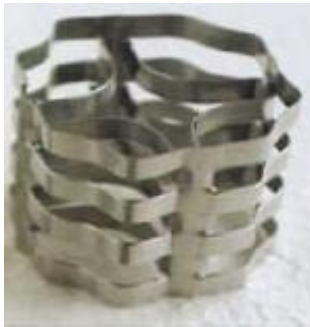
(شكل III-12) : تمثل مختلف انواع ادماج ال PCM عن طريق بنيات معدنية [31]
