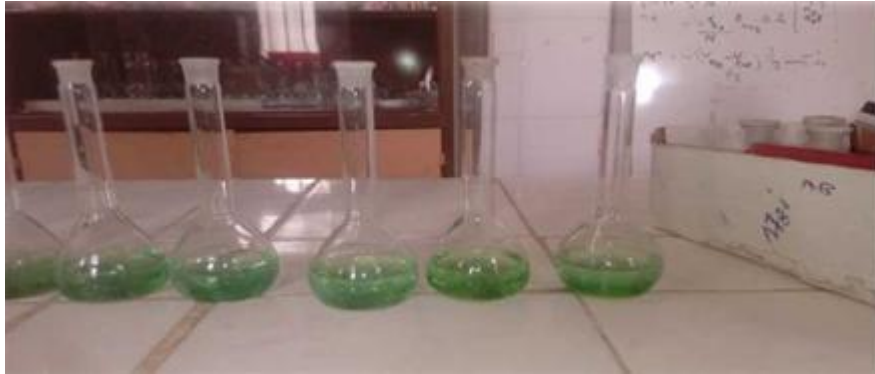
الشكل رقم (16): يمثل صورة للعينات بعد اضافة كلا من Réactif1 و Réactif2 للامونيوم
