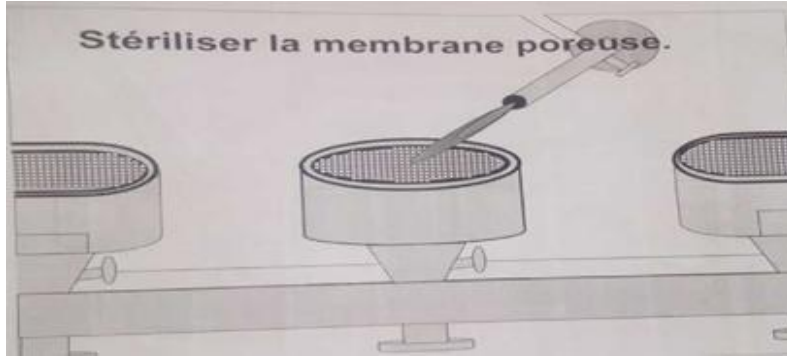
الشكل رقم (21): يمثل صورة لتعقيم الداعمة المسامية باللهب
