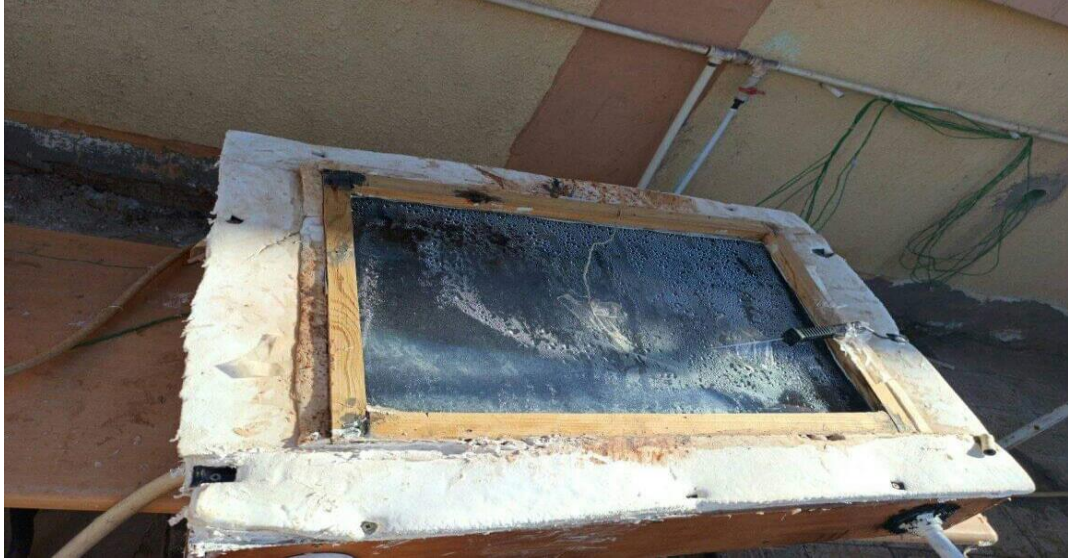
صورة توضح التركيب التجريبي للمقطر المعدل (2)
