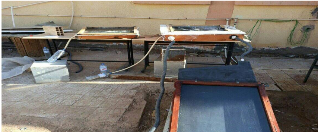
صورة توضح التركيب التجريبي للمقطر المعدل (2)
