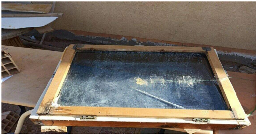
صورة توضح التركيب التجريبي للمقطر الشاهد (1)
