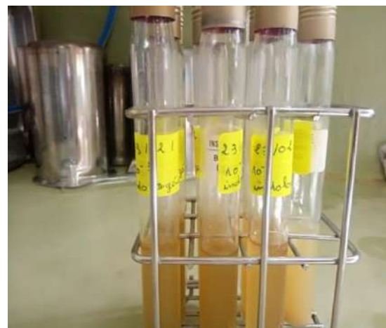
Photo 19: Recherche de la flore indologène dans les laits pasteurisés analysés.
