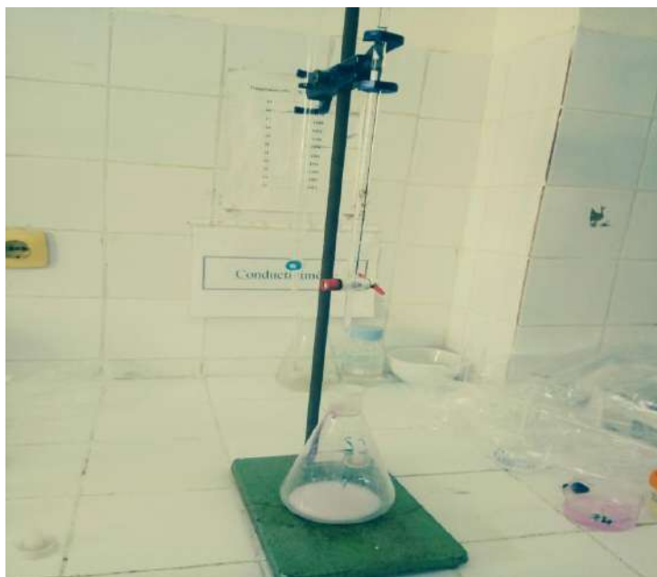
Photo 3: Mesure d'acidité titrable en °D pour le lait reconstitué.
