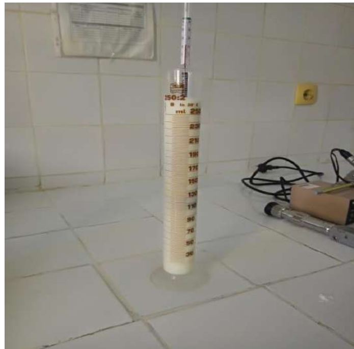
Photo 4: Mesure de la densité du lait reconstitué par lactodensimètre.
