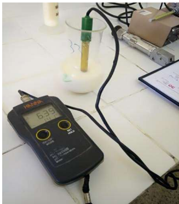
Photo 2: Mesure du pH par le pH mètre.
