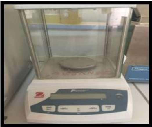
Balance analytique OHAUS corp (item PA214)
