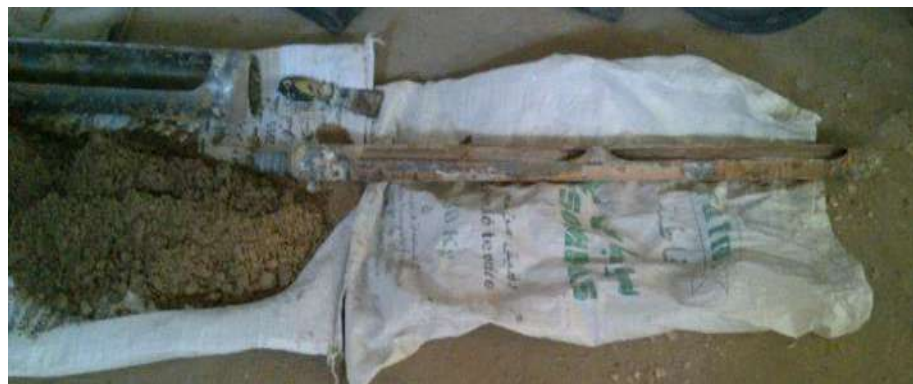
Annexe 17 : Carottage avec une tarière électrique au centre de sebkha de N'goussa.
