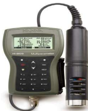
Fig.3. 10 Multiparamètre PH et cond Hanna HI 9829.
