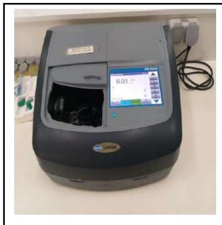
الشكل 25. معايرة شوارد الحديد الثنائية بواسطة جهاز مطياف الأشعة فوق البنفسجية
