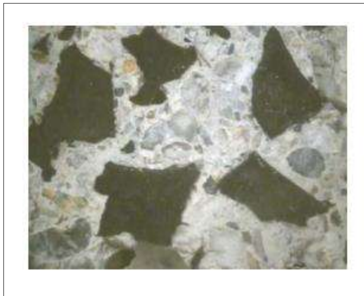
Figure III.18 : Incorporation des granulats caoutchouc dans une matrice cimentaire.( NGUYEN T., 2010)
