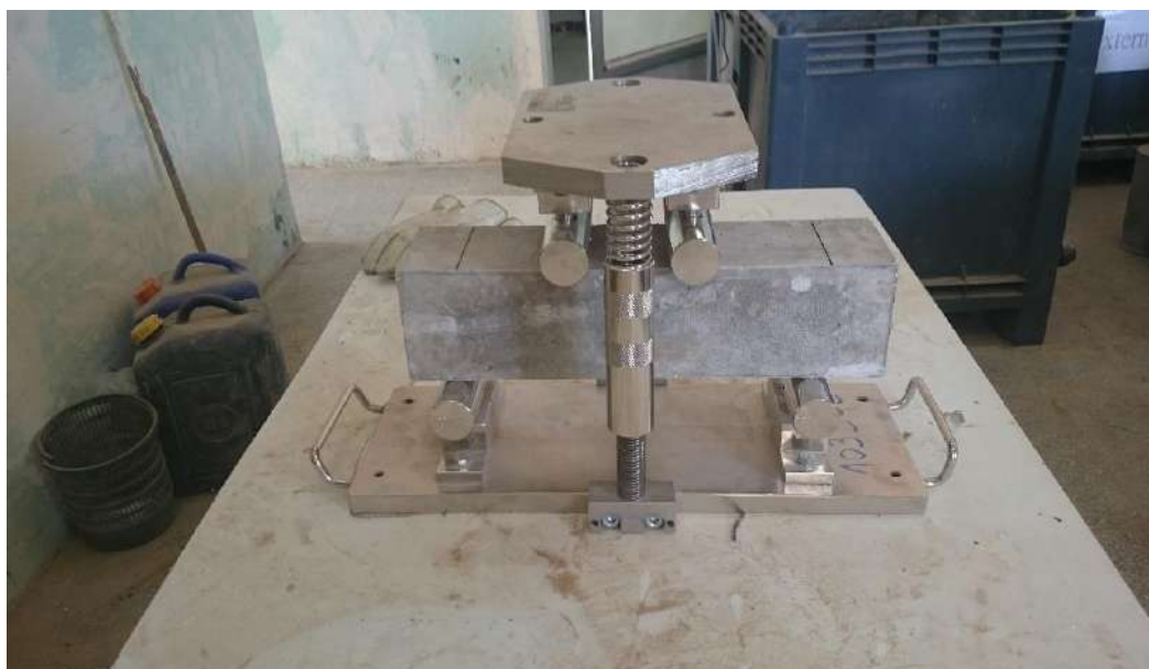
Photo V.9 : Eprouvette avant l'essai de flexion + le dispositif de flexion.
