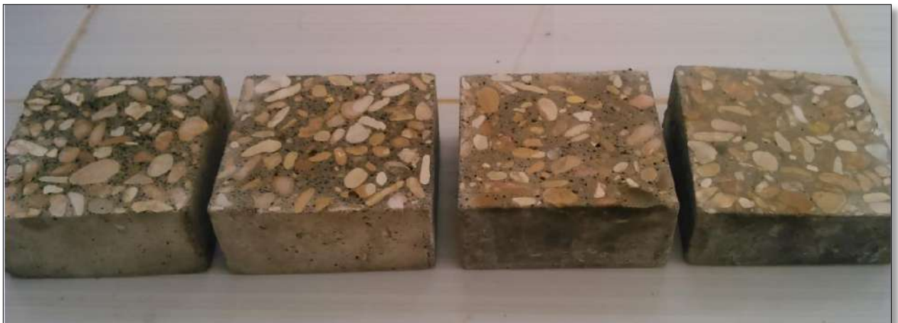
Photo V.10: Epreuve de béton à différentes teneurs en poudre de caoutchouc.
