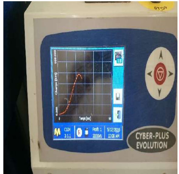
Photo V.5 : Charge appliquée sur C2 (25s durée de chargement).
