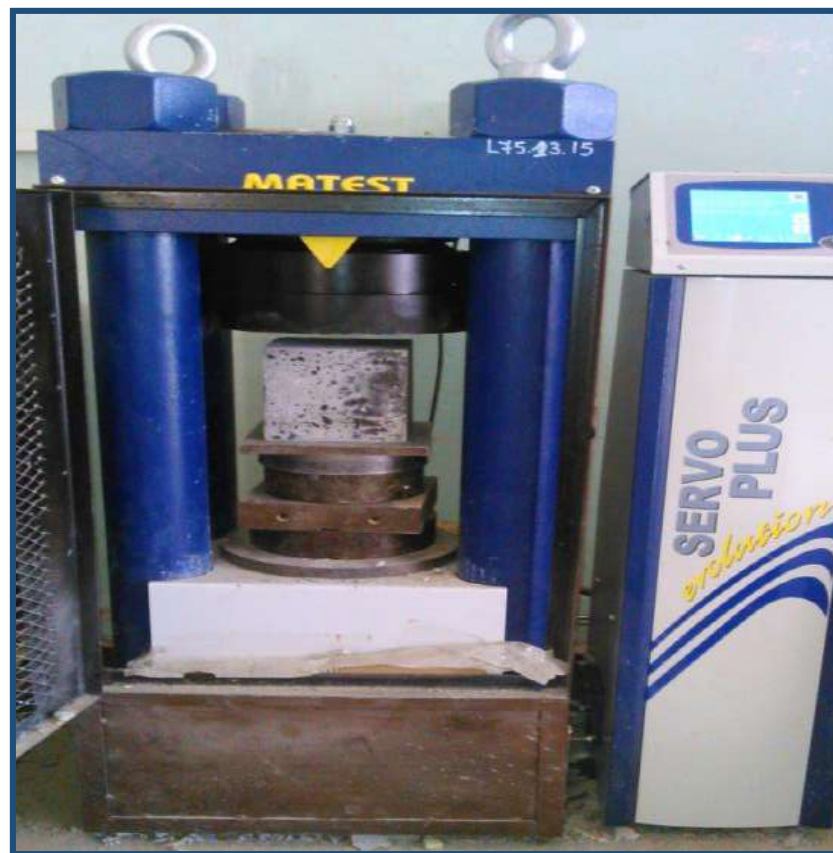
Photo IV.13: Presse d'écrasement utilisée.
