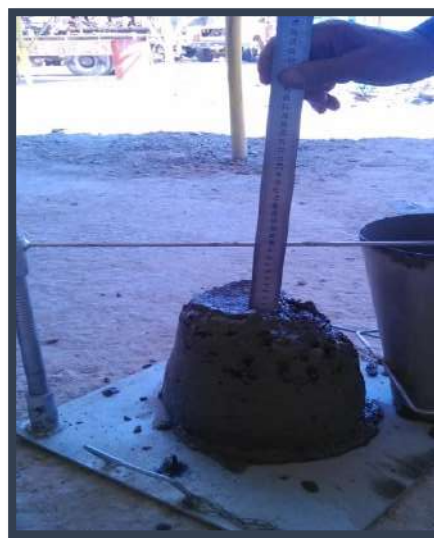
Photo IV.12: Mesure de l'affaissement.
