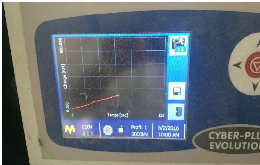
Photo V.7 : Courbe d'évaluation de la charge en fonction de temps (60s).
