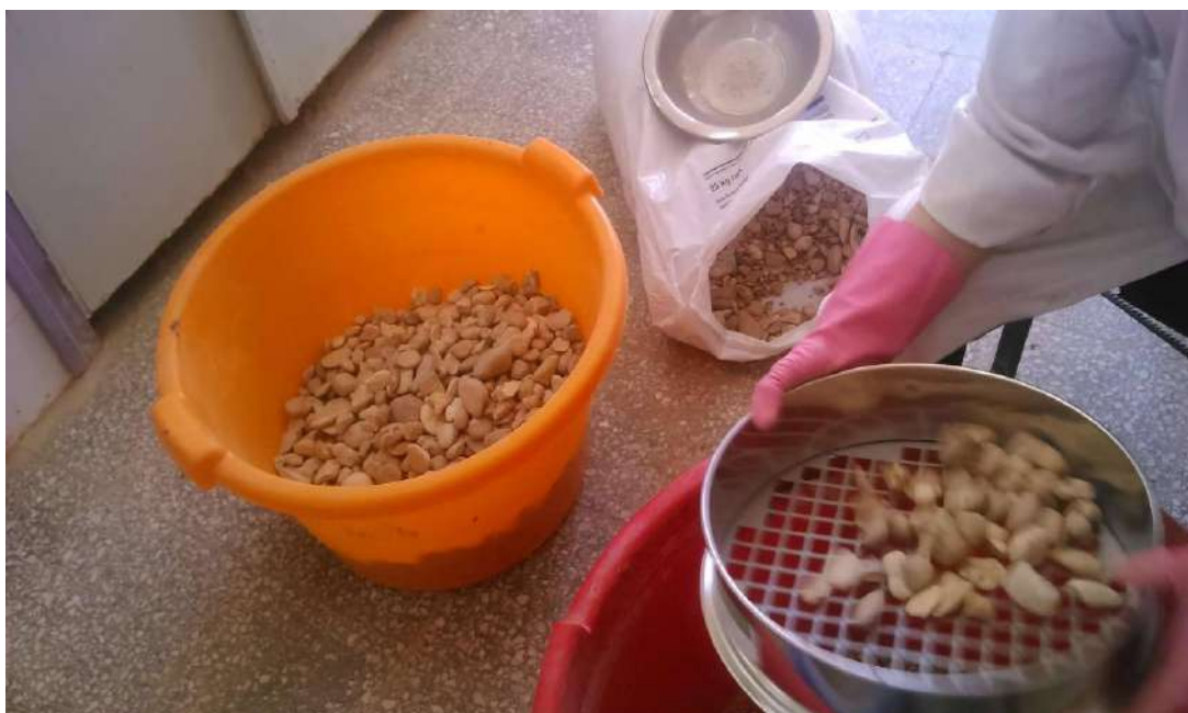
Photo IV.2 : Séparation les classe de gravier.
