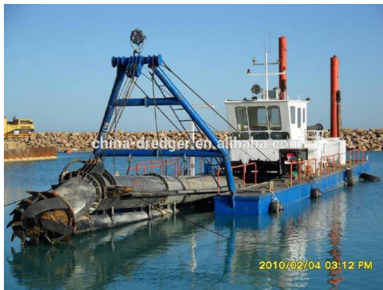
Figure II.7 : Extraction de gravier roulé – drague suceuse –
