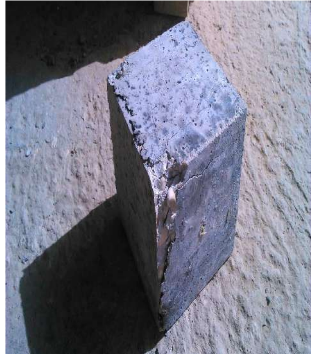
Photo V.2 : Epreuve après l'essai d'écrasement RC.
