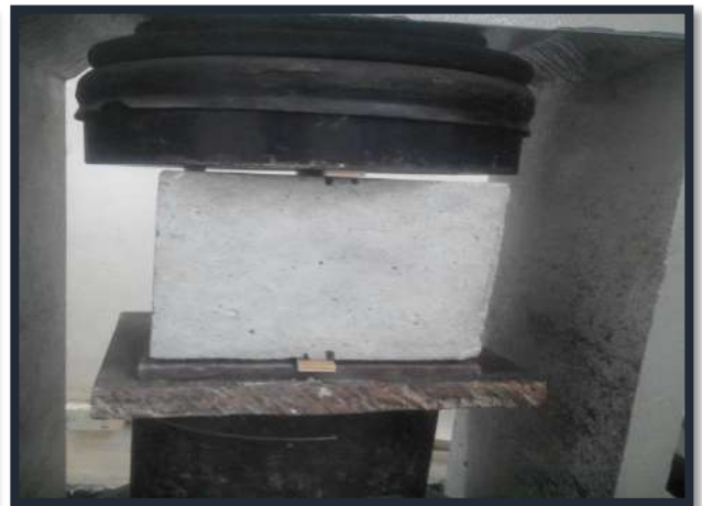
Photo IV.17: Essai de traction par fendage.
