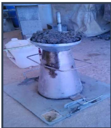
Photo IV.11: Remplissage du cône par le béton.
