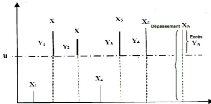
FIG. 1.5 – Représentation des excès  $Y$  issus des dépassements  $X$  au-delà d'un seuil  $u$ .
