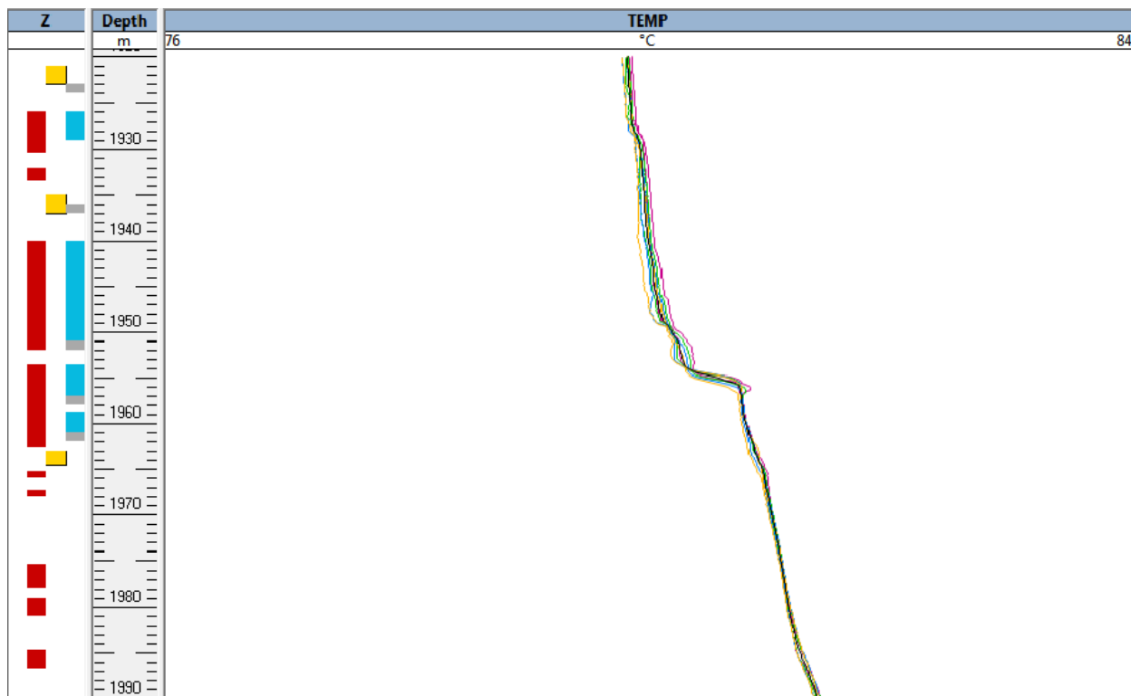
Figure IV.11: Présentation des logs de Température (TEMP)
