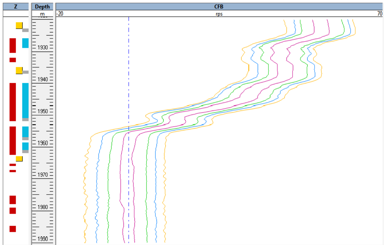
Figure IV.12: Présentation des logs de Spinner (CFB)
