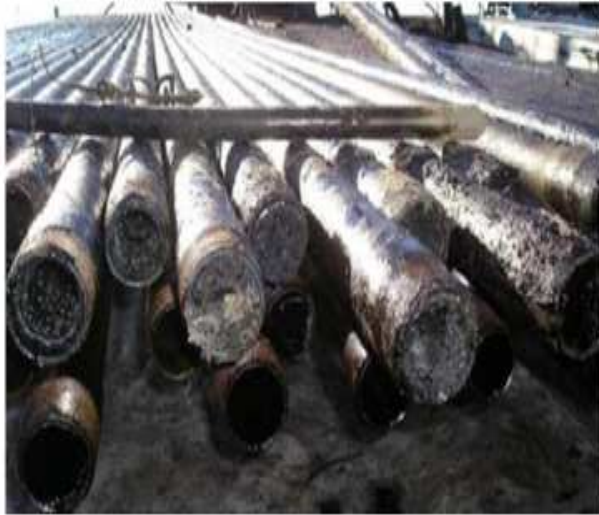
Figure II.17: Dépôt d'Asphaltène dans les Tubings de Production [24].
