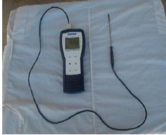
الشكل 22: جهاز مقياس درجة الحرارة.
