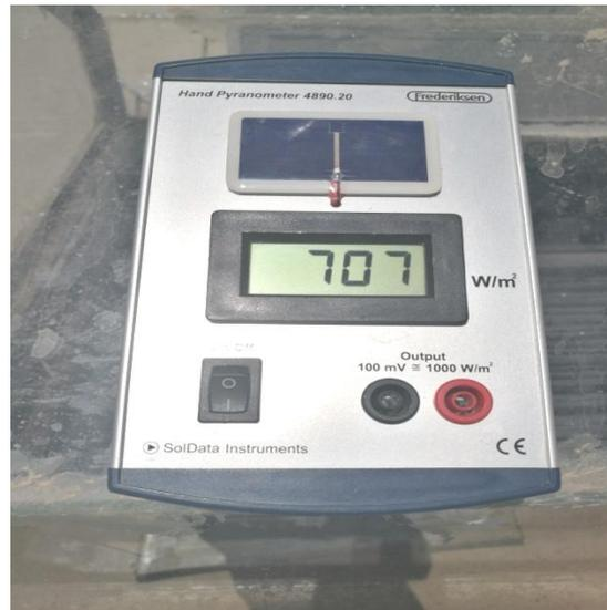
الشكل 23: جهاز مقياس شدة أشعة الشمس.
