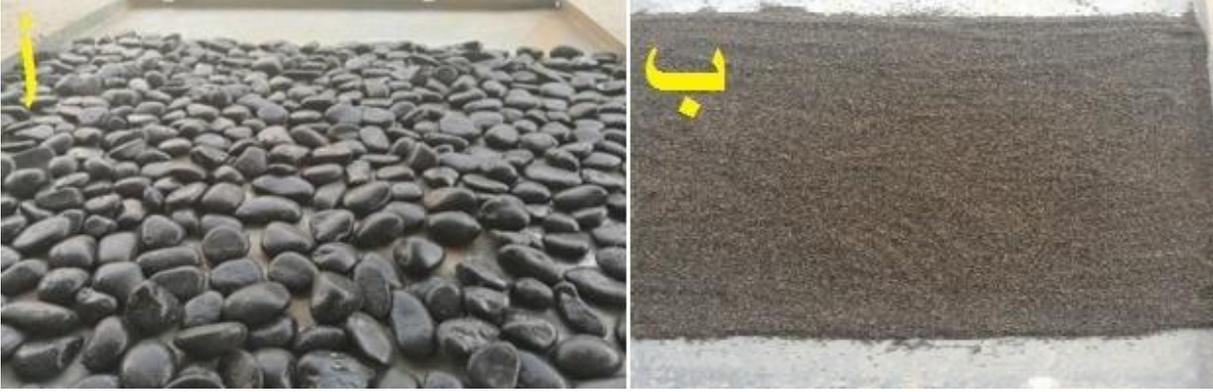
الشكلين 20: (أ)- صورة توضح نوع الحصى المستعمل. (ب)- صورة توضح نوع الرمل المستعمل.
