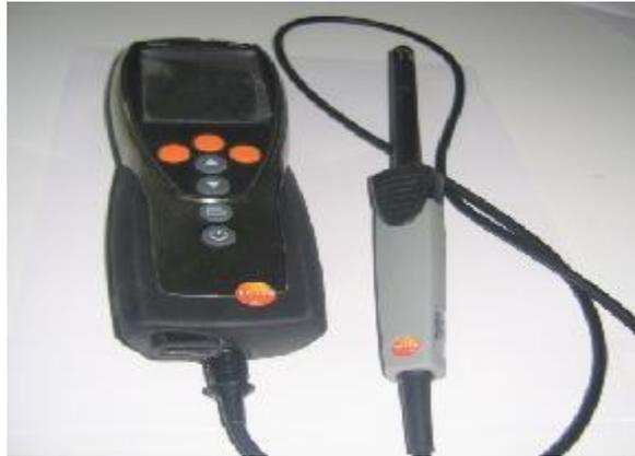
الشكل 21: جهاز مقياس الرطوبة و درجة الحرارة Test 645.
