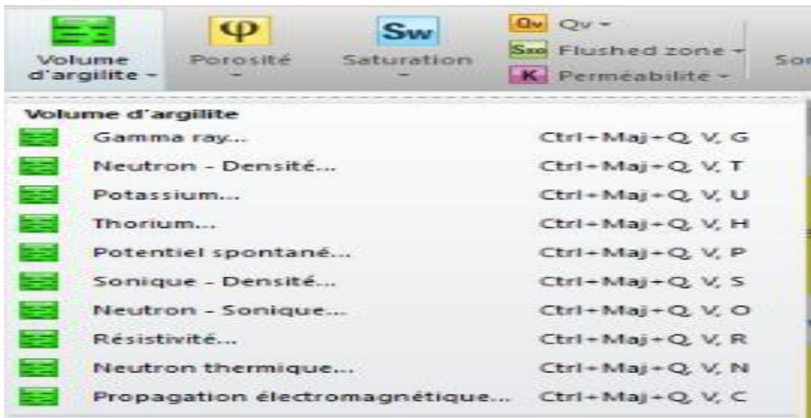
**Figure (III. 08) : Explication de détermination du  $V_{sh}$  par techlog.**
