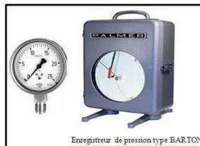
**Figure (II.11) :** Enregistreur de pression type BARTON [14]
