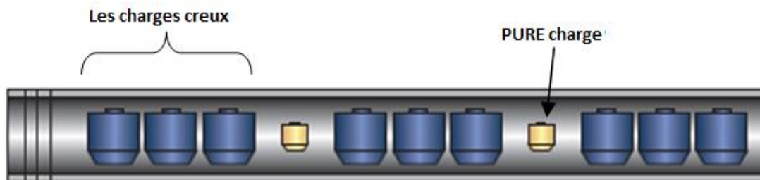
Figure IV.6: l'installation des charge sure les canaux du système " PURE charge "
