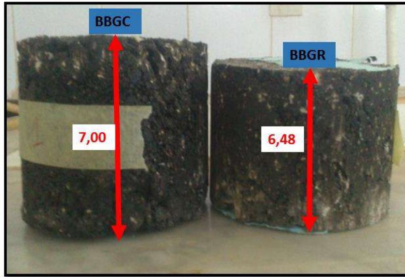
Photo V.10. Épaisseurs des éprouvettes BBGR et BBGC en (cm).
