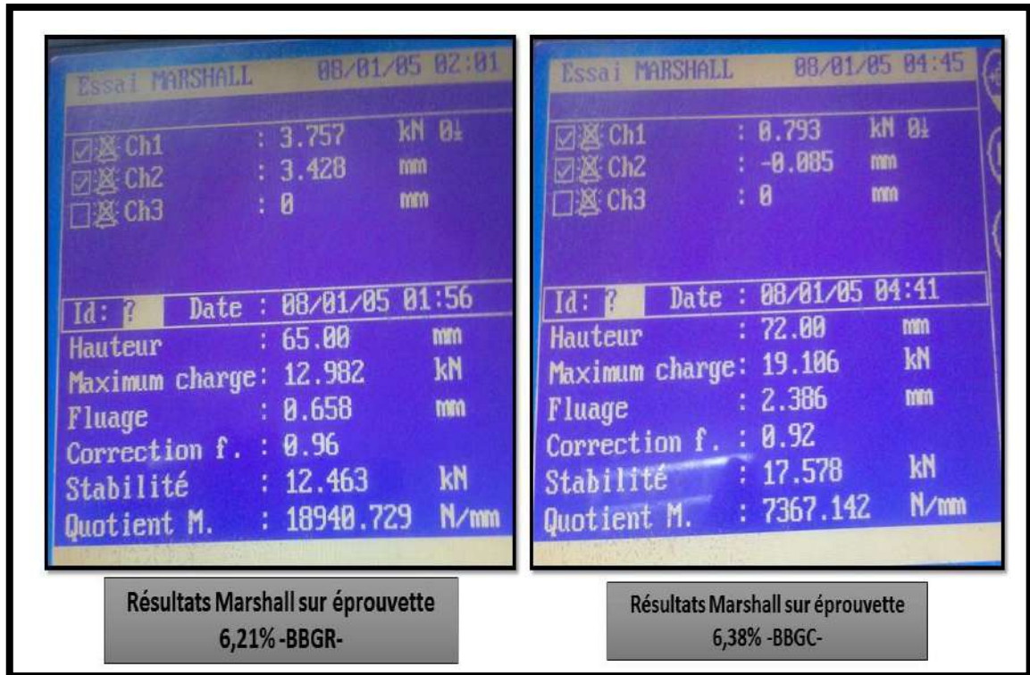
Photo V.12. Résultats Marshall de deux éprouvettes BBGR et BBGC.
