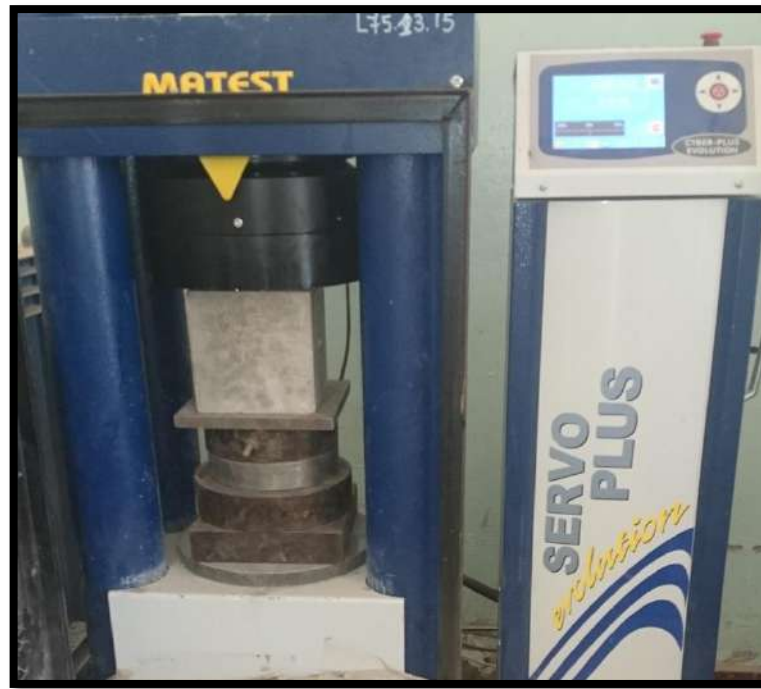
Photo V.17. Essai de résistance à la compression.
