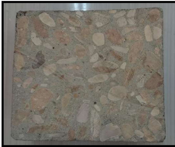
Photo.V.23. Coupe d'une éprouvette GR cubique.
