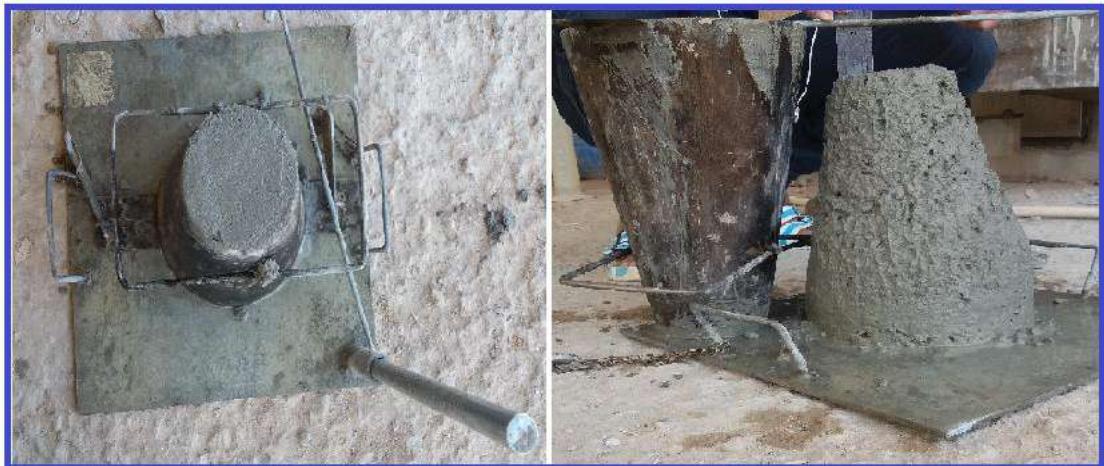
Photo.V.16. Mesure de l'affaissement
