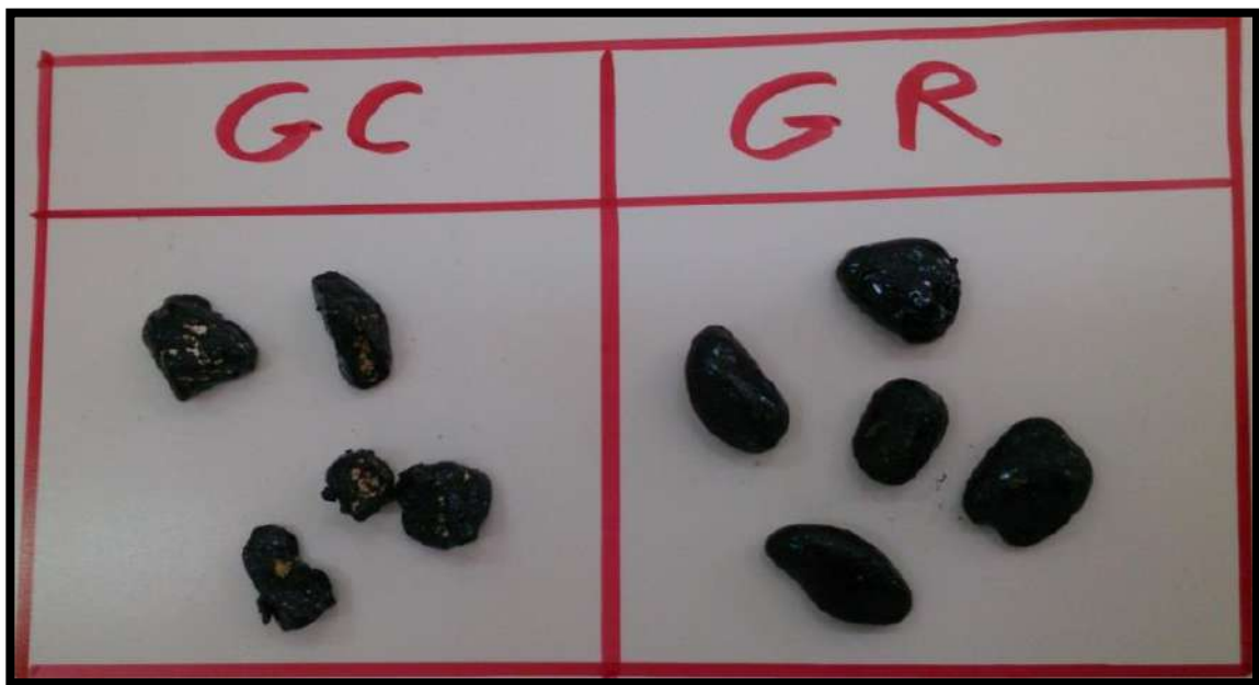
Photo V.13. Résultats du désenrobage sur le GR et GC.
