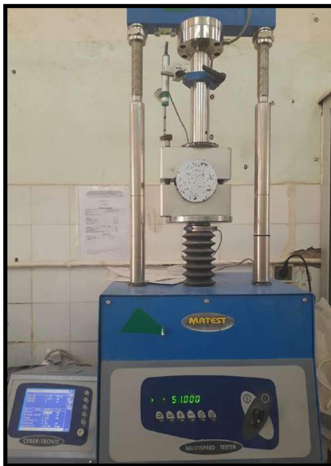
Photo .V.2. Dispositif de l'essai Marshall.
