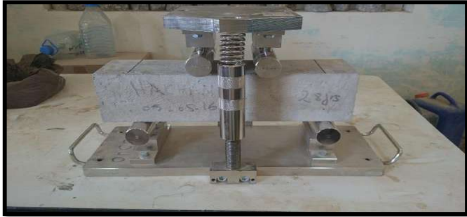
Photo.V.19. Dispositif de flexion à 4 points.
