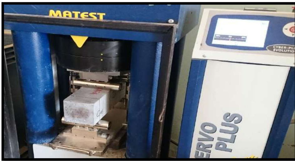
Photo.V.20. Essai traction par flexion.
