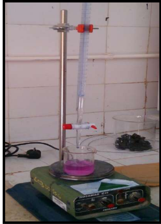
Photo V.7. Opération du titrage de l'acide Chlorhydrique par l'Hydroxyde de Sodium.
