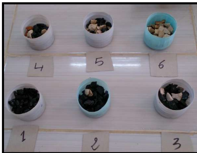
Photo V.5. Les 06 Mélanges du GC de l'essai de désenrobage. Pour les granulats calcaires comme notre cas, procéder comme suit :
