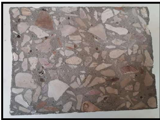
Photo.V.24. Coupe d'une éprouvette GC cubique.
