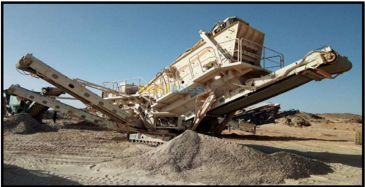
Photo IV.5. Concasseur à mâchoires, modèle Lokotrack LT200HP de la marque METSO
