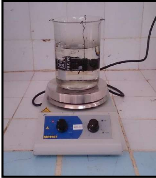
Photo V.9. Désenrobage du Mélange 100% enrobé par l'eau bouillante.
