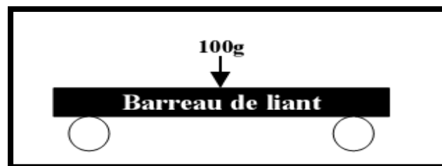
Figure II.16. Schématisation du principe de l'essai BBR.
