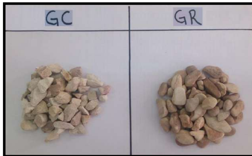
Photo IV.2. Gravier Roulé (GR) et Gravier Concassé (GC) utilisés.
