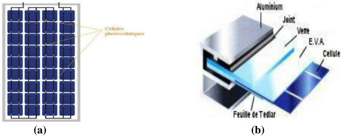
Figure (I.10): Module photovoltaïque.
