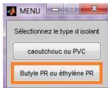
Figure III.31 : Fenêtre pour le choix du type d'isolant
