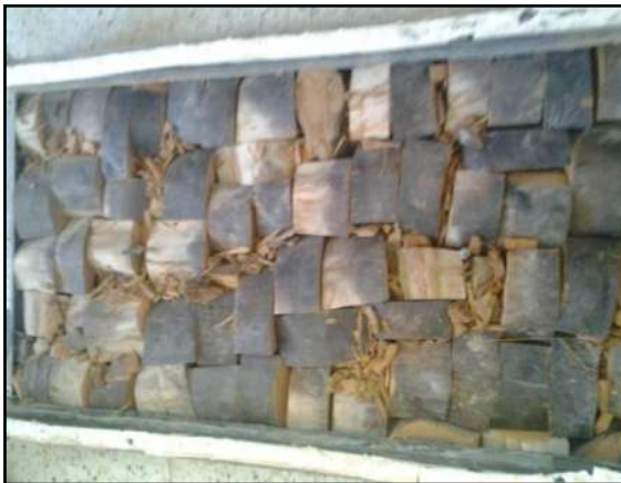
Photo. IV. 2a. Photo du capteur solaire avec isolant pétiole (pièce).
