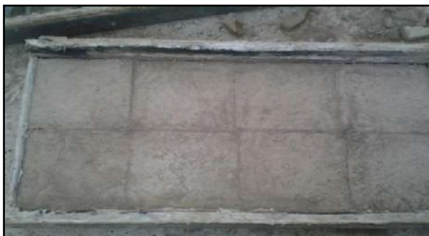
Photo. IV. 4a. Photo du capteur solaire avec isolant pétiole poudre + plâtre.
