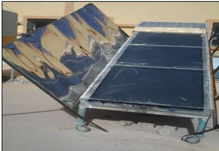
Photo (V-4): Photographie du capteur solaire plan avec un réflecteur sur le coté gauche.
