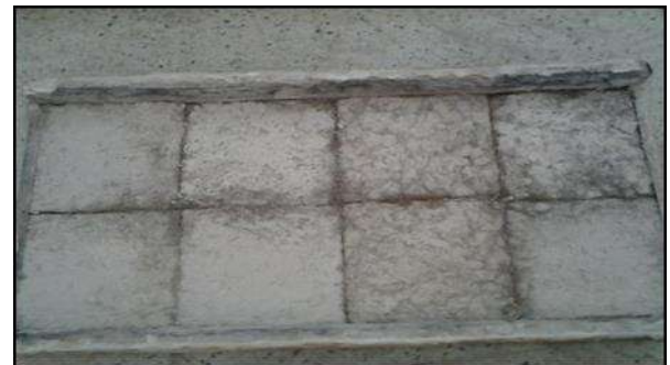
Photo. IV. 4b. Photo du capteur solaire avec isolant fibres poudre + plâtre.
