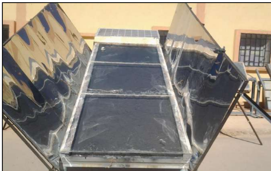
Photo (V-1): Photographie du capteur solaire plan avec réflecteur.
