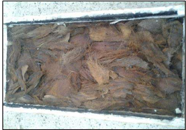
Photo. IV. 2b. Photo du capteur solaire avec isolant fibres (pièce).
