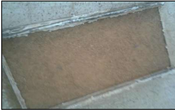
Photo. IV. 3a. Photo du capteur solaire avec isolant pétiole (poudre).
