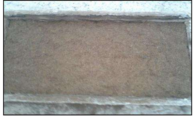
Photo. IV. 3b. Photo du capteur solaire avec isolant fibres (poudre).
