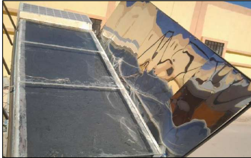
Photo (V-3): Photographie du capteur solaire plan avec un réflecteur sur le coté droit.
