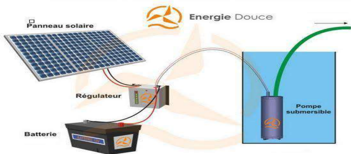
Figure II.1 Principe de fonctionnement du pompage avec stockage électrochimique
