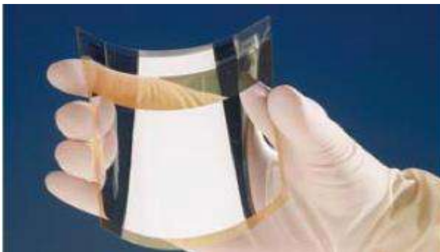
Figure I-14 : Cellule solaire plastique de grande dimension (100 mm x 100 mm)
