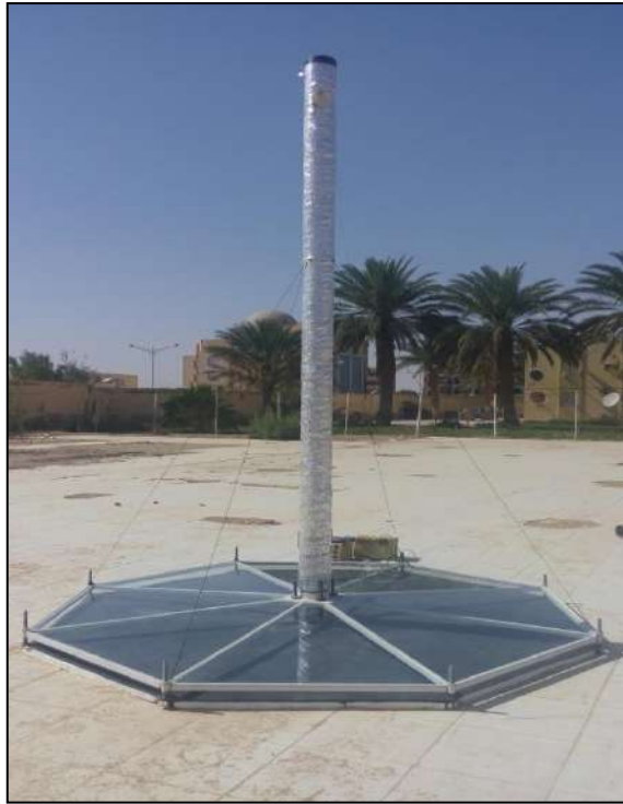
Figure 23: Prototypé de la cheminée solaire réalisée
