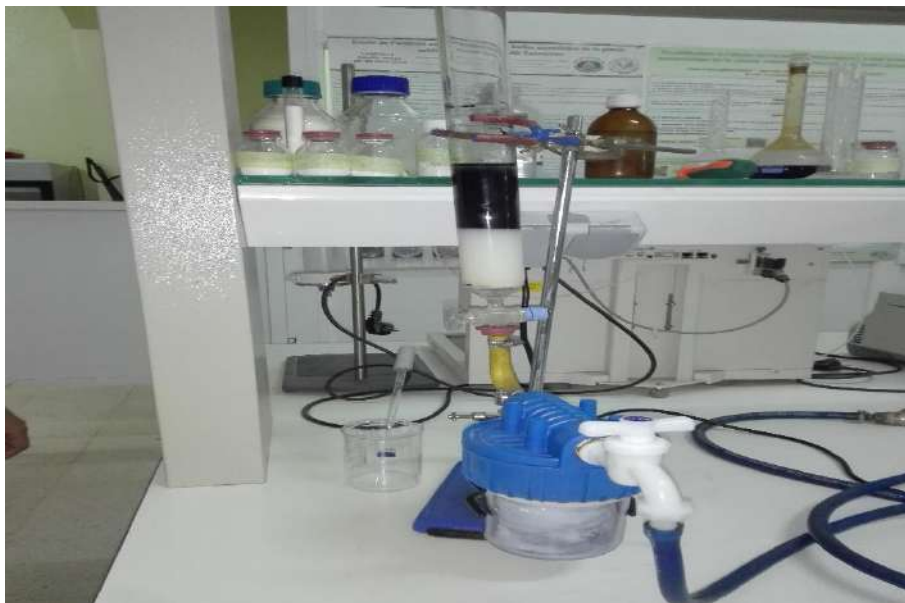
Fig. 44 : L'adsorption de MO par le biofiltre
