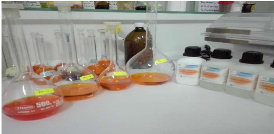
Fig. 43 : Teste de l'effet de pH sur l'adsorption de MO
