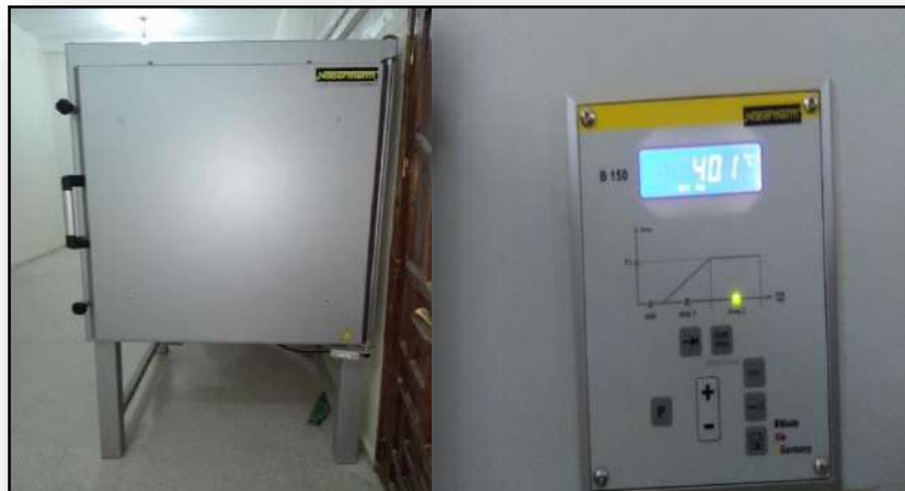
Fig. 36 : Le four de carbonisation
