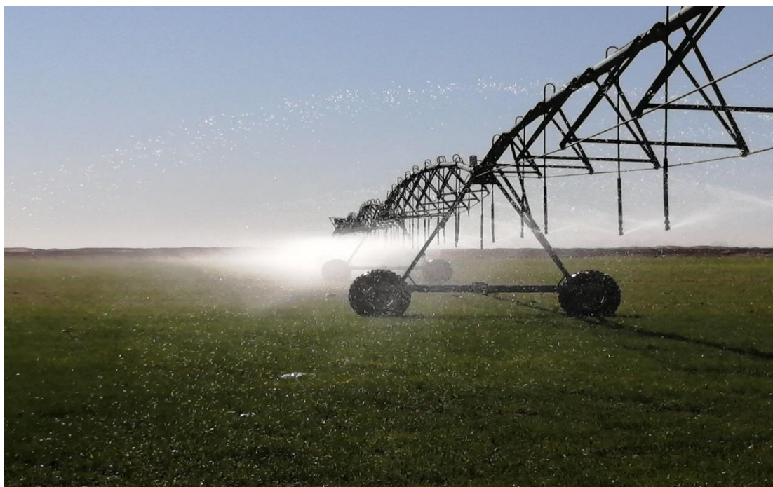
Figure I.14 Le pivot d'irrigation
