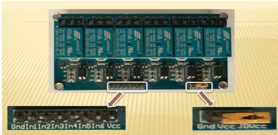
Figure III.4: Vue d'ensemble d'une rampe de relais.
