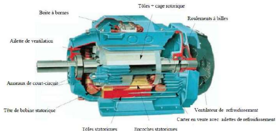
Figure I.1 Eléments de constitution d'une machine asynchrone [01]
