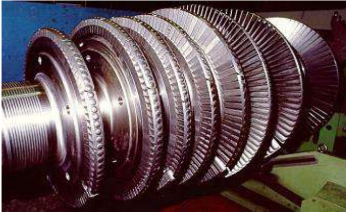
Figure II.8: Rotor à 8 étages [8]
