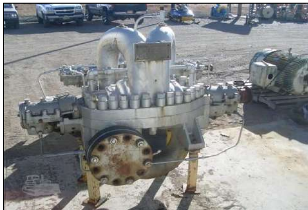
Figure II.4 : pompe centrifuge modèle Bayron-JACKSON
