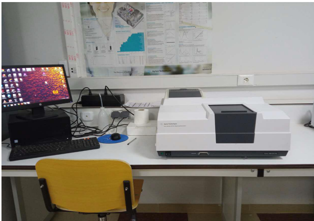
Figure2.12: Dispositif expérimental de la spectroscopie UV-visible [CRAPC-Ouargla]
