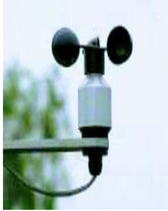
الشكل(1-3): جهاز قياس سرعة الرياح
