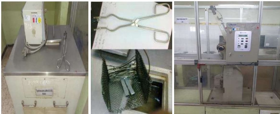
Figure III.13 Machine essai de résilience (Mouton pendule Charpy)
