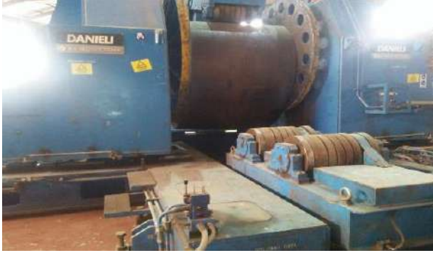
Figure I.10 Machine de préparation de bobine
