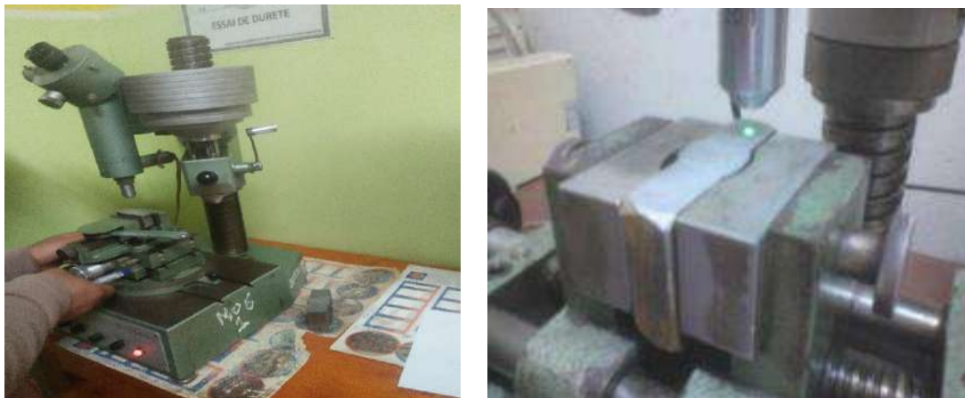
Figure III.16 Procédure et machine de dureté (Type Vickers)
