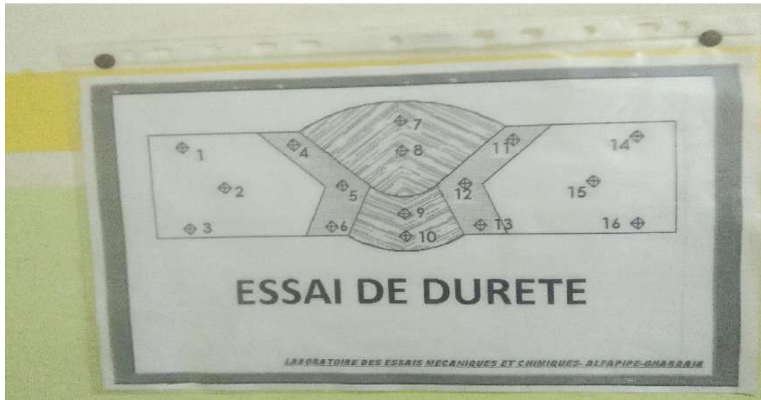
Figure IV.4 Eprouvettes avec joint de soudure bout à bout pour la dureté Vickers (Acier X70)
