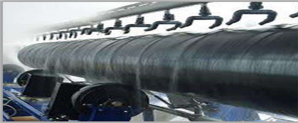
Figure I.44 Tunnel de refroidissement des tubes revêtus
