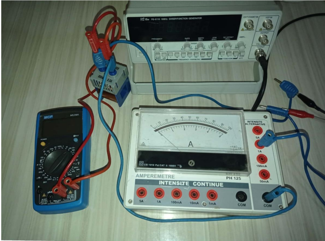
شكل 10.11: التركيب التجريبي لتجربة دراسة تأثير التردد على ممانعة الملف.
