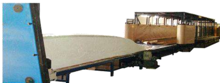
Image.1 : Tunnel de mousse & transporteur
