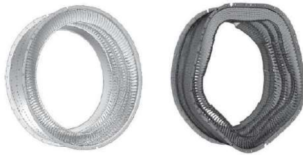
Figure I.3 Modèle à éléments finis d'une section de stator d'un moteur d'aéronef
